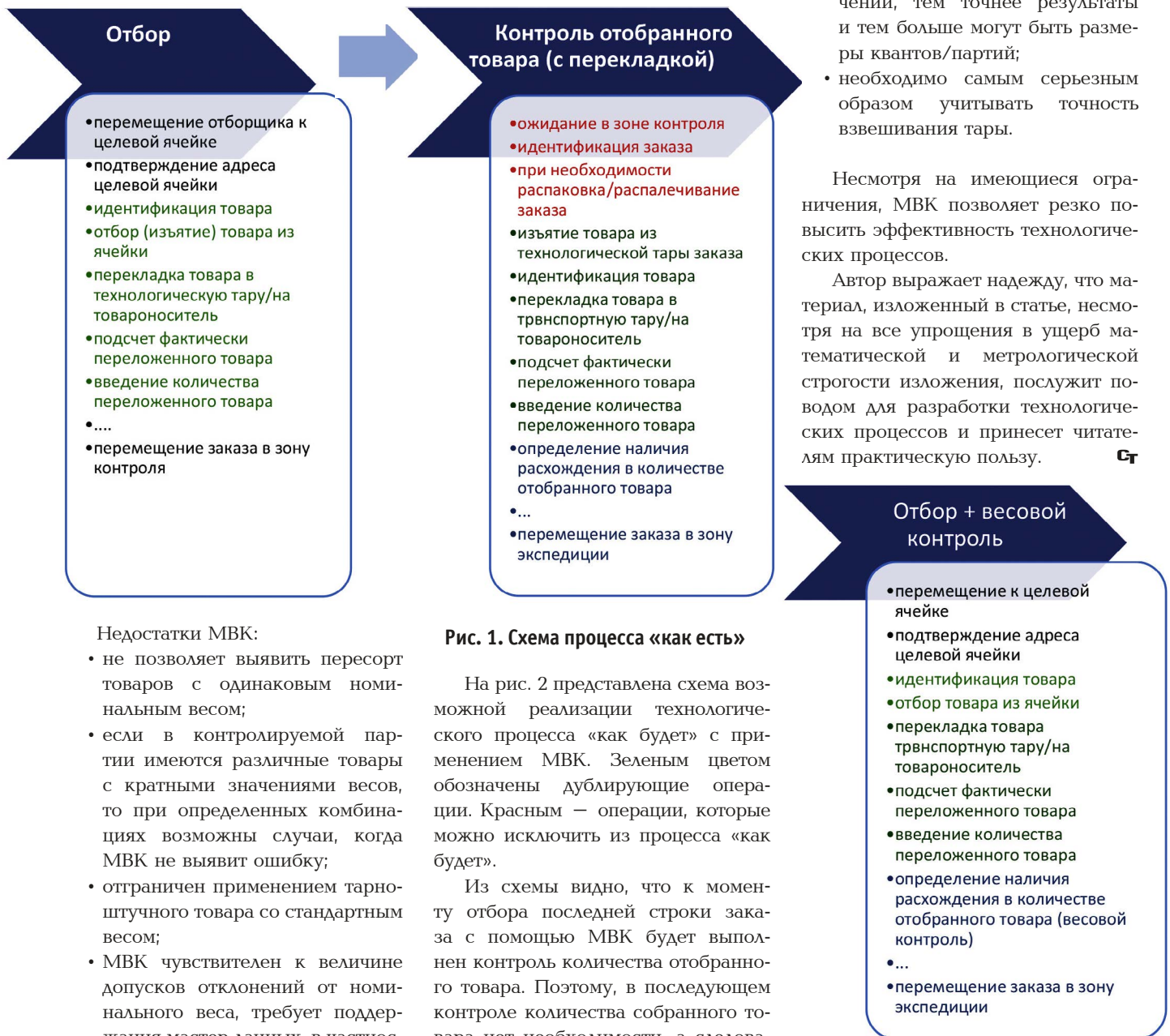
Рис. 2. Схема концепта процесса «как будет» с применением МВК
